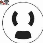
抜止形コンセントの極配置 (JIS C 8303 付図A-17)
