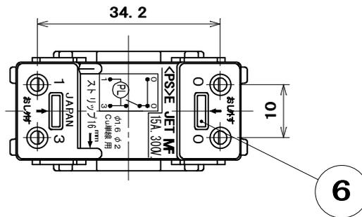
適用電線：銅単線 φ1.6mm、φ2mm
