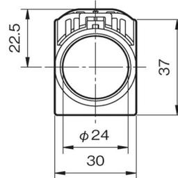
☆ 締付ナットへ突起を設けたことにより、図1の通り、2種類のパネルカット寸法へそのまま取付けることができます。
