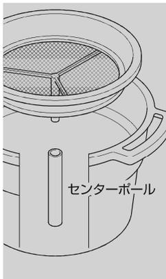
網付カバーにはセンターポール方式を採用。不整地や傾斜のある場所に設置しても、**カバーと容器の間にすき間ができません。**また水位に合わせてカバーが上下するので、**補水の回数を減らすことができ、長時間の効果を実現します。**
