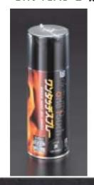
用途 暖房器具、焼却炉、煙突、加熱部品 つや消しブラック(日本塗料工業会 DN-20の近似色) 耐熱温度 650 内容量 300ml 標準塗布面積 1.5~2.0m<sup>2</sup> 乾燥時間 常温24時間以上
