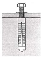
③取付け物を置き、 ボルトをねじ込む。
