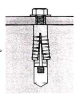
④ボルトを締付け、 取付け物を固定 する。
