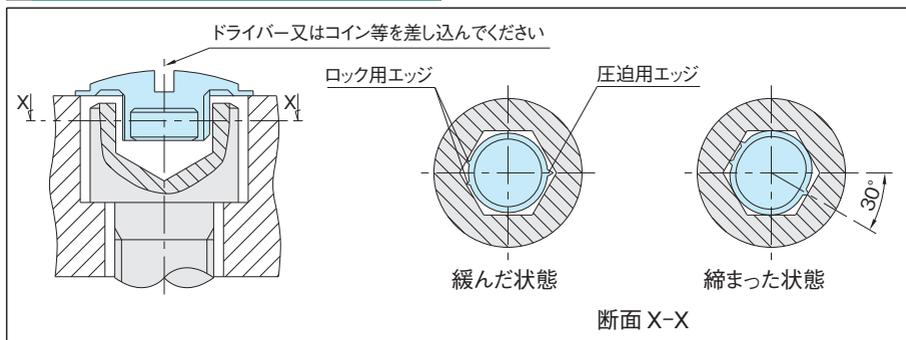
ドライバーまたは、コインを使ってキャップを30°回すと、3つのエッジが六角穴の側面を圧迫し、強い保持力が生まれ、キャップは確実にロックされます。反対方向に回すと緩み、繰り返し使うことができます。
