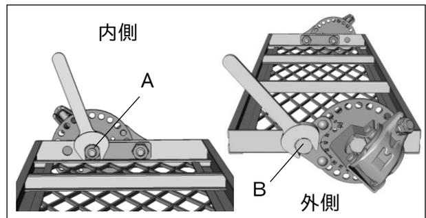
④ 目盛りがずれないように注意しながら固定プレートの2本のピンを差し込み、B、Aの順にボルトとナットをしっかりと締め付けてください。
