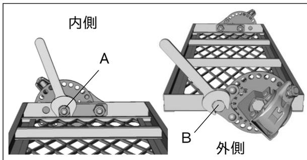
② 裏返して、Aのナットを1/6回転、Bのボルトを6回転ほど緩めてください。(スパナサイズ21mm)
