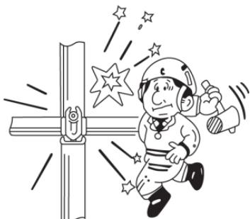
工事終了の際、クランプをはずすのにボルトをハンマー等でたたいてはずすと再使用が不可能になりますので必ずスパナをご使用してください。
