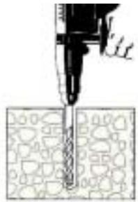
ポイント(測点)のボルトの位置に合わせてハンマードリルで下穴を開ける
