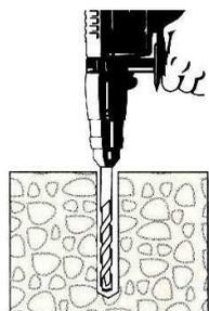
①ポイント(測点)のボルトの位置に合わせてハンマードリルで下穴を開ける
