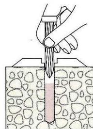
④プレートをセットしてネイルを差し込む
