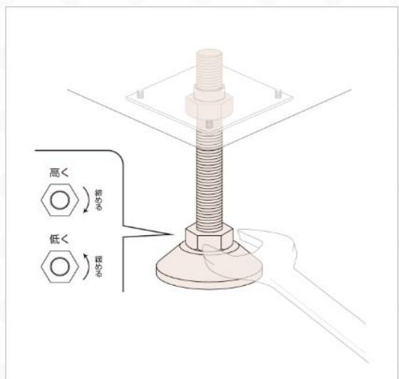
①設置する機械等のネジ穴にアジャスターべルトを差し込みます。
