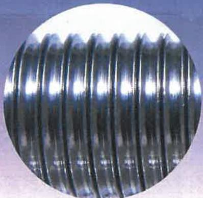
ハイブリッドボルトはネジ山の1山1山にあたかもスプリングワッシャーを嵌め込んだようなバネ構造になっているため、単に接触摩擦のみに頼っていた従来の標準ネジや夾雜物を併用した他のロックボルトと異なって、外部からの衝撃や振動等の大きな負荷を素材のもつ弾性を利用して、構造的に吸収します。また、アルミ鋳造品のような硬度の低い素材の雌ネジを用いて繰返し使用した場合でも、大きなロック作用が得られます。
