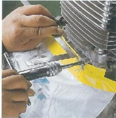
**2** ラatchet型のT型タップハンドルで、干渉物を避けながら作業を進めた。この作業の際も、締め付け面に対して直角にタッピング加工を施さなくてはならない。この作業時も金尺を目安にしよう。
