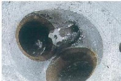
**2** 時折、燃焼室側からタップの状況を確認する。エアブローを行い、切り粉を除去するのも良い。驚きの実力でプラグ穴が拡大されていく。ちなみのこのヘッドはホンダの空冷360cc用。四輪です。
