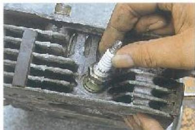
**6** スムーズにプラグをネジ込むことができるか指先で確認する。しっかりと作業を行えば、間違いないスムーズに入るはずだ。これでガッチリとトルクを掛けて締め付けても大丈夫だ。
