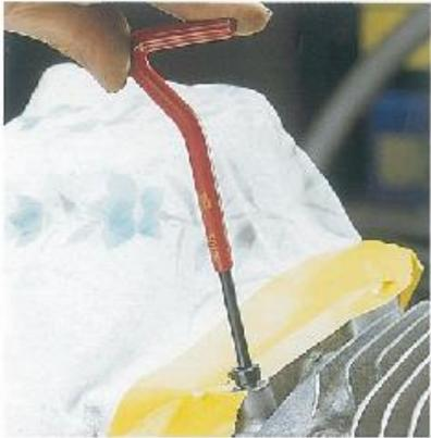
**4** M6 P1.00mmのリコイルを挿入工具にセットし、慎重に挿入していく。この際に斜めに入れてしまったり、山飛ばしをしてしまうと、最初からやり直しになってしまう。慎重に作業を進めよう。
