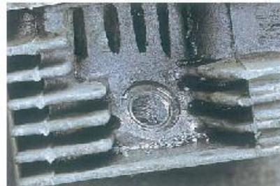
**3** パイロットタップをガイガイとネジ込み、下穴加工が完了した。パイロットタップでない場合は、タップ加工の前に下穴加工をドリルで行わなくてはならない。この際はドリルの傾きに要注意。
