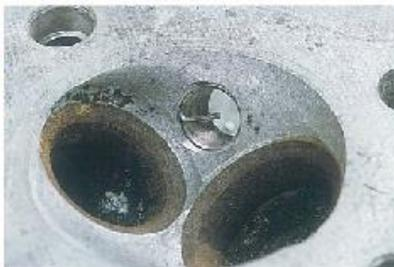
**5** 燃焼室側からも確認し、リコイルが飛び出していないことを確認する。もしも飛び出してしまう場合は、短いリコイルに交換しなくてはならない。確認後、折取工具で先端を切り落とす。
