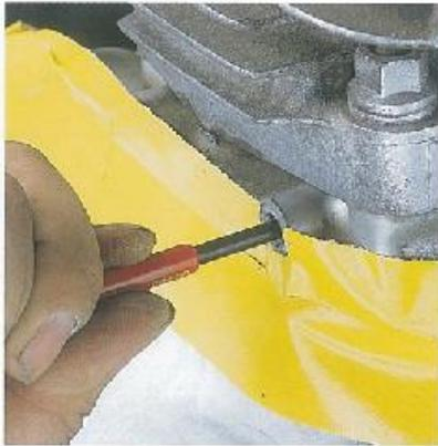
**5** 挿入作業が完了したら、付属の折取工具で、リコイルの先端の90度曲がった部分(タンク)を切り取る。切り取ったタンクが穴の中に残らないように注意しよう。残ったままだとリコイルにダメージを与えてしまうのだ。
