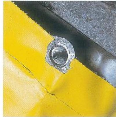
**3** これがタップ加工の完了した状態だ。内部の切り粉が完全に除去できるように、防錆スプレーやパーツ洗浄液をシュッと塗布して掃除機で吸い取るのが良い。こんな際には工業用掃除機が便利だ。
