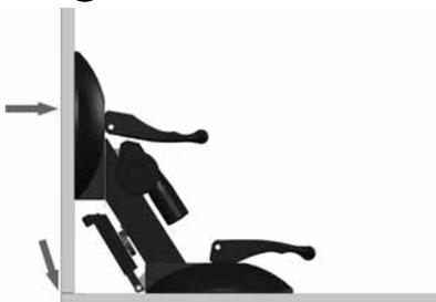
DE Vertikale Glasscheibe an Winkelsauger pro positionieren.
