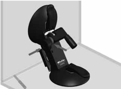
**SE** Vrid på räffelskruven för att ställa in excenterskivan så att den ligger an mot taget. Genom blockeringen „lagras“ den tidigare inställda positionen (spaltens höjd).
