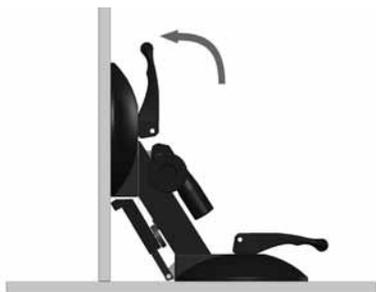
**IT** Fissare la lastra verticale spostando la leva. Posizionare il secondo VERIFIX PRO direttamente sulla lastra verticale. Fare aderire prima alla lastra orizzontale, poi a quella verticale.
