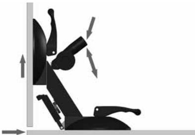
**IT** Azionando la leva il vetro si solleva alla larghezza voluta della fessura; in questa posizione si applica il collante. !!!ATTENZIONE!!! questa procedura non è necessaria utilizzando collanti liquidi!!! continua con la figura 17
