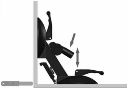
**DE** Betätigung des (schwarzen) Hebels um Glasscheibe anzuheben, mit Hilfe der Fühlerlehre die exakte Höhe des Spaltes definieren. Achten Sie darauf, dass beide Verifix Winkelsauger Pro gleichzeitig betätigt werden.
