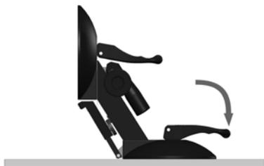
**IT** Posizionare VERIFIX PRO nel punto desiderato sulla lastra di vetro orizzontale. Fissare la posizione azionando la leva, si deve avvertire chiaramente la resistenza causata dalla produzione del vuoto! (Vale per qualsiasi manovra di fissaggio ventose!).
