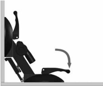
**DE** Position fixieren durch Umlegen des Kipphebels.
