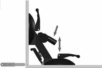
**SE** Lägga om (den svarta) spaken för att lyfta glasskivan. Definiera spaltens exakta höjd med hjälp av ett slitsmått. Se till att bägge Verifix vinkelsugare Pro manövreras samtidigt.
