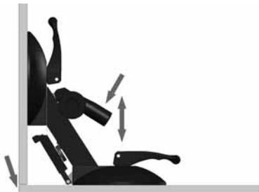
**SE** Släpp efter försiktigt/långsamt (!) till den lagrade positionen. Om två eller fler positioneringsverktyg används, släpper man efter ett efter ett, ej samtidigt! Låt förhärda i detta läge.
