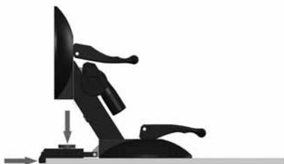
SE Lossa spännanordningen med räffelskruven, skjut den mot glaskanten och fixera med räffelskruven.
