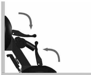
**IT** Staccare le due leve e togliere la ventosa angolare. Se necessario eliminare l'adhesivo in eccedenza ed eseguire l'indurimento finale.
