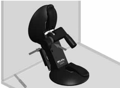
**IT** Girando la vite zigrinata regolare il disco eccentrico in modo che si trovi sulla barra di rinforzo. Con il bloccaggio si "fissa" la posizione precedentemente impostata (larghezza della fessura).
