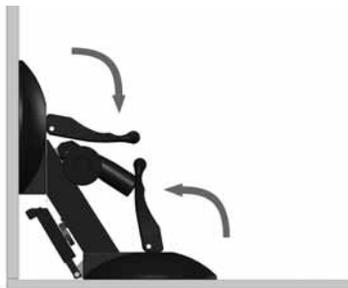
**SE** Lossa bägge spakarna och avlägsna fixeringshjälpmedlet. Avlägsna överflödigt lim om så behövs, och låt sluthärda.
