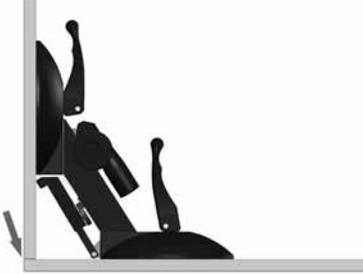
IT Posizionare il VERIFIX PRO con la lastra verticale fissata nel punto esatto d'incollaggio
