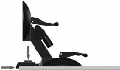
DE Anschlagvorrichtung über die Rändelschraube lösen, gegen die Glaskante schieben und über die Rändelschraube fixieren.
