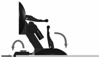
**IT** In alternativa: la staffa di arresto è già stata irregolata in base allo spessore del vetro: Figura 1-10 da non considerare: Posizionare VERIFIX PRO sul bordo del vetro utilizzando la staffa, quindi attivare la leva orizzontale. Continuare con punto 11.
