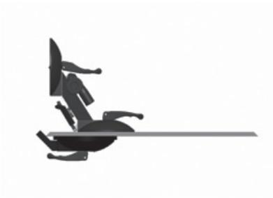
DE Anschlagvorrichtung hochklappen.
