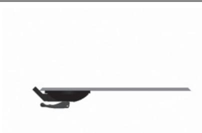
**DE** Achten Sie darauf, dass die Kunststoffplatte gleichmäßig an der Glaskante anliegt. Falls sich auf einer Seite ein Spalt ergibt, wiederholen Sie den Vorgang.
