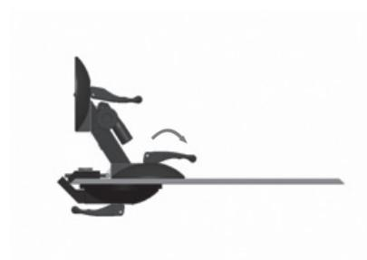
**DE** Legen Sie nun den Kipphebel der horizontalen Saugscheibe um. Dabei muss der Widerstand der Vakuumerzeugung deutlich spürbar sein. (Gilt für jedes Ansaugen!)
