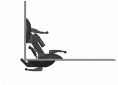
DE Positionieren Sie die vertikale Glasscheibe, indem Sie sie auf den Gehrungsanschlag setzen und gegen die vertikale Saugscheibe klappen.
