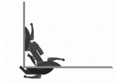
DE Drücken Sie die Glasscheibe im Bereich der Saugscheibe leicht an und fixieren Sie sie durch umlegen des Kipphebels.
