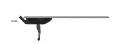
**DE** Drücken Sie die Kunststoffplatte des Verifix® Gehrungsanschlages gegen die untere Gehrungskante und legen sie den Kipphebel um.
