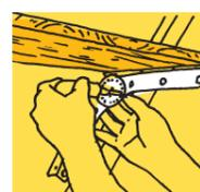
最後に好みの角度を決めた後、貫通した穴を見つけ、そこに付属のボルトを通して締め付けてください。もう一方も同様に締め付けてください。
