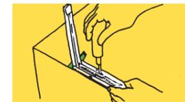
金具を印に合わせて、付属ネジの長い方を使ってネジ留めしてください。金具の中心の穴が中心になるように金具を垂直にしてネジ留めしてください。
