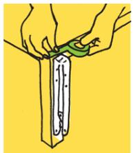
金具の取付位置を決めます。棚受け金具の長い方が脚や壁側にくるようにしてマーキングしてください。垂直位置にも線を引いてマーキングします。この時水平・垂直になるよう注意してください。
