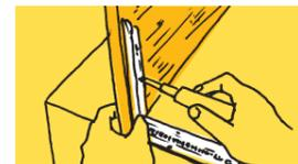
棚板をスムーズに上げ下げ出来るように壁から3mmくらいの間隔をあけて短い方のビスを使って棚板を取り付けてください。もう一方の金具も同様に取り付けます。
