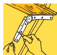
棚板の取付場所にも水平になるよう印を付けた後、棚板・金具を付属のネジで取り付けてください。もう一方の金具も同様に取り付けます。
