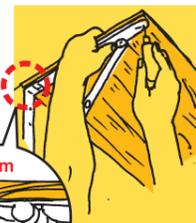
棚板をスムーズに上げ下げ出来るように壁から5mmくらいの間隔をあけて短い方のビスを使って棚板を取り付けてください。(5mmの間隔を測るために、台紙に目印を用意しています。) もう一方の金具も同様に取り付けます。
