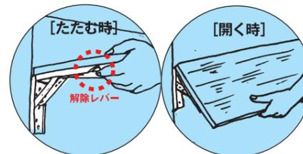
棚板を少し持ち上げて、左右の金具の解除レバーを同時に押す
