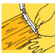
棚板に合わせて金具の位置を決めます。付属のネジを使ってネジ留めしてください。
