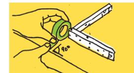
水平・垂直の取付位置にマスキングテープ等で印を付けます。※左右の金具の取付位置は、必ず水平にして取り付けてください。水平でない場合は、正しく作動しない恐れがあります。
