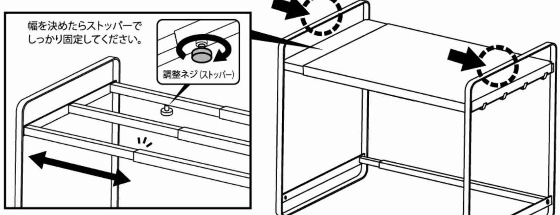
※ガタつきがある場合は、各部品をネジで締めなおして微調整してください。
