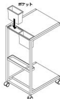
\*組み立て後、製品にガタつきが発生する場合は各部のネジの締め付け箇所を調整して削減してください。
