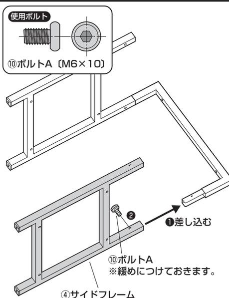
**3 補強パイプを取付けます。**
