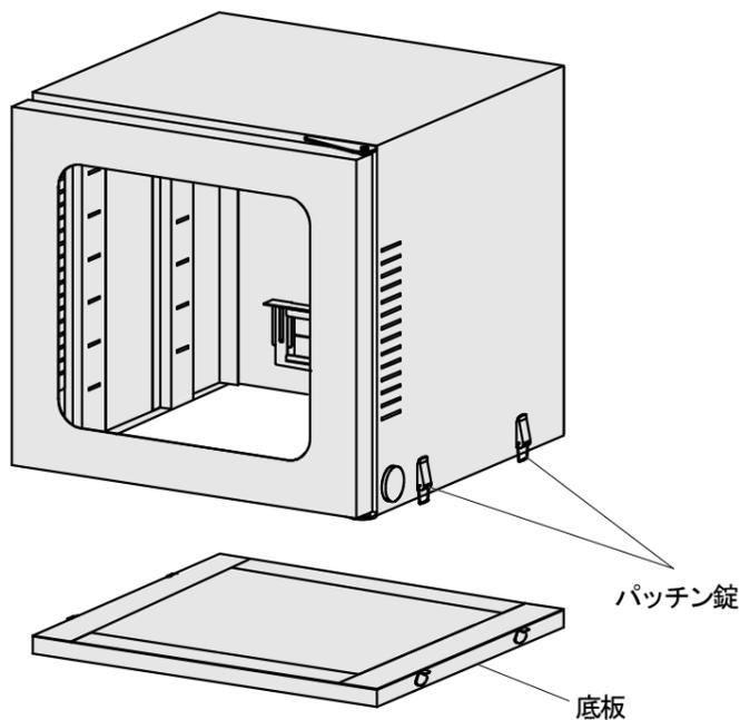
2 背面のプラポイントを外しパネルを取外します。マウスなどを取付ける場合は側面のグロメットに切り込みを入れそこから配線を入れます。
