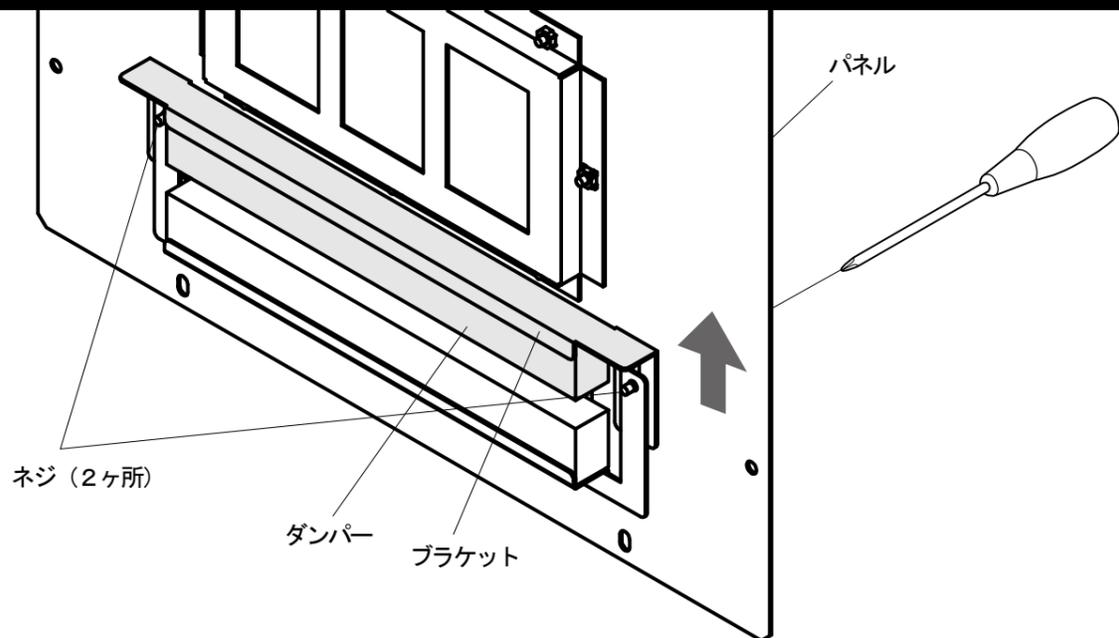
4 ケーブル配線後、隙間があかないようにダンパーを下へ押さえてネジを締めてください。パネルを再び取付けて完成です。
