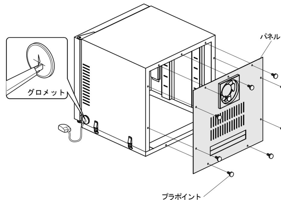
3 ケーブルの取出し口は、プラスドライバーでネジを2ヶ所緩め、ダンパーとブラケットを上へスライドさせてケーブル配線を行って下さい。
