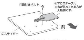
(2)マウステーブル取付けブラケットで固定します。
