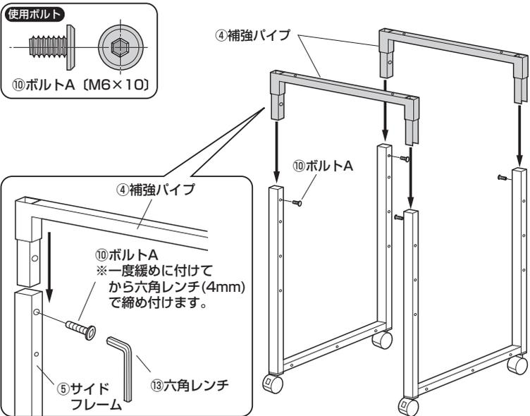
**3 リーンフォースメントを付属ボルトで取付け、各棚板をボルトBで固定します。**
