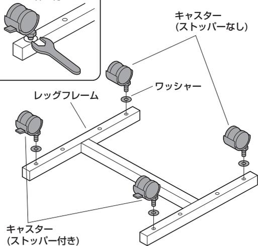
2 横に倒した状態で、メインフレームにレッグフレームを取付けます。
