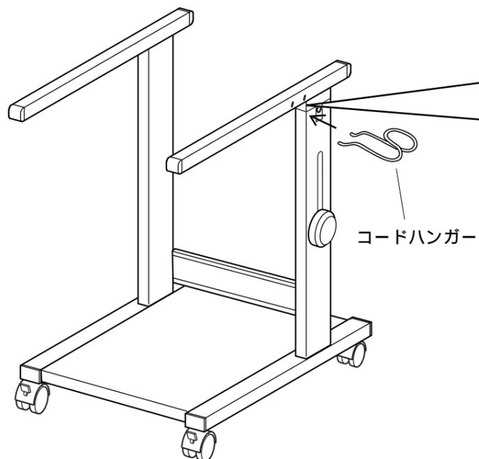
コードハンガーは先端を水平にしてサイドフレームの穴差込んだ後下方にまわすと取付けられます。
