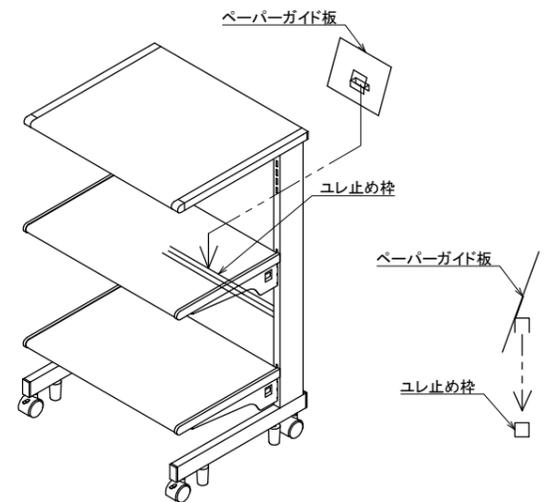
7 ペーパーストッカーにキャスターを取り付け、左右フレームの間に設置します。最後に各部増し締めをして完成です。
