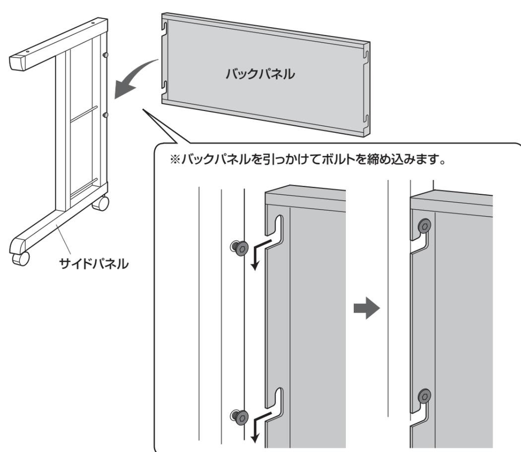
※バックパネルを引っかけてボルトを締め込みます。
