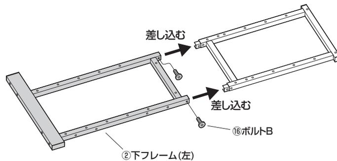
※ゆるめに付けていたボルトBをしっかりと締付けます。
