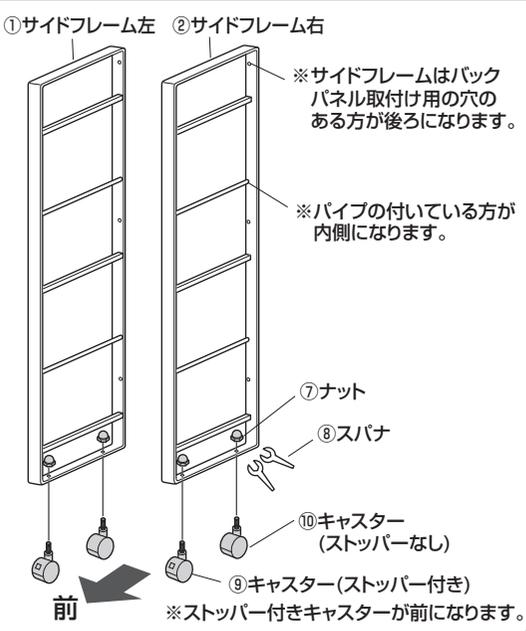
**2 サイドフレームにバックパネルを取付けます。**
