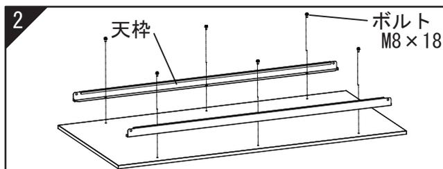
天枠2本をボルトで仮止めします。
