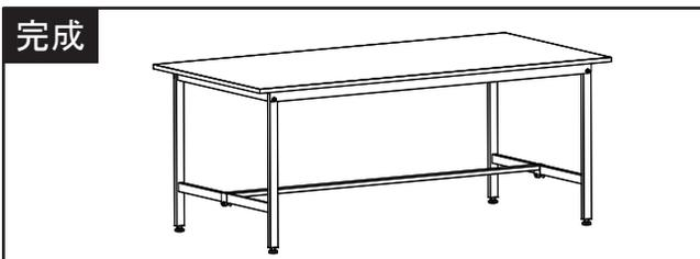
各ボルトを、ツナギ→鳥居脚と天枠→天板の順にプラスドライバー(#3)又はスパナで締めこんで完成です。
