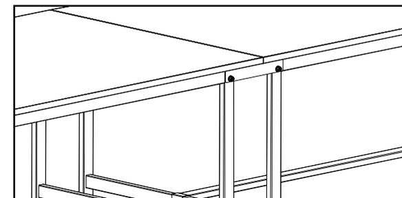
前後ともに鳥居脚を取り付けるボルトで共締めします。必ず2枚共セットしてください。
