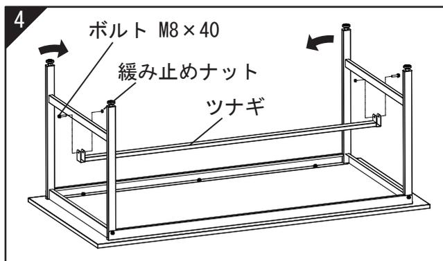
鳥居脚を内側に寄せながら、ツナギを図のようにはめ込んでボルトナットで仮止めしてください。
