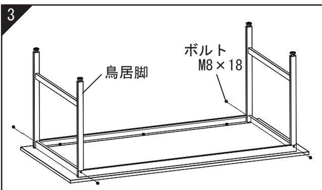
プラスドライバー(#3)又はスパナを用いて、鳥居脚をボルトで固定します。
