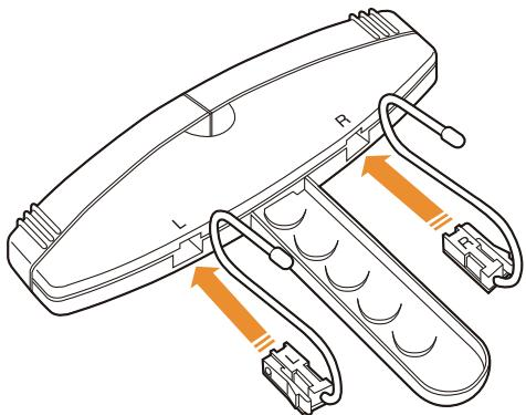
ホルダーのR/Lを確認し、本体底面の角穴に差し込みます。レバーのツメが『カチッ』と音がするまでしっかりと入ったら完成です。
