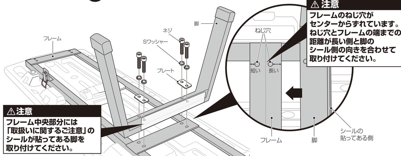
**2** 右図のようにフレームの端に脚を取り付けます。
