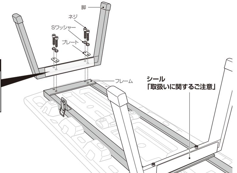
**3** 下図のように、もう一方の端に脚(シールなし)を取り付けます。
