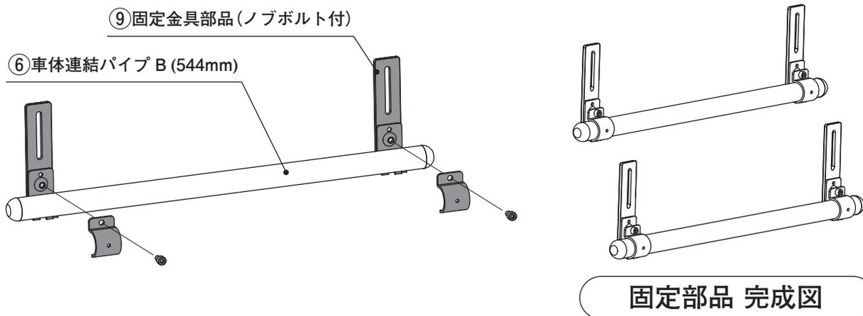
6-2. 前項で製作した「固定部品」を(図1)のように、車体の取付孔の位置に合わせて取付けてください。(車体の取付孔に保護キャップがしてある場合は外してください。)
