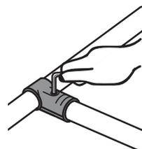
◎指定締め付けトルク **M6ボルト： 9.8N・m {100kg・cm}**
