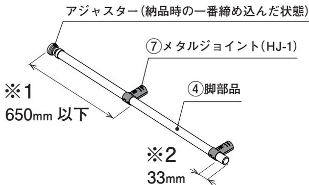
左図の「※1」寸法は、「ワーカーゴー」の下段の棚高さになります。650mm以下の範囲で好みの高さに取り付けてください。
