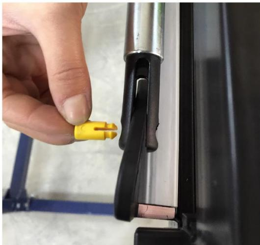
②黄色の留め具を押し込み固定します
