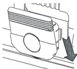
2. カセットホルダー側へカッターカセットを押し込みます。
