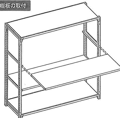
上段、下段は上下棚受の上に、中段は棚受の上に棚板を載せます。
