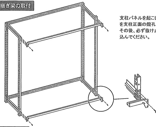
支柱パネルを起こして、継ぎ梁両端部の爪を支柱正面の鍵孔に嵌め込みます。
