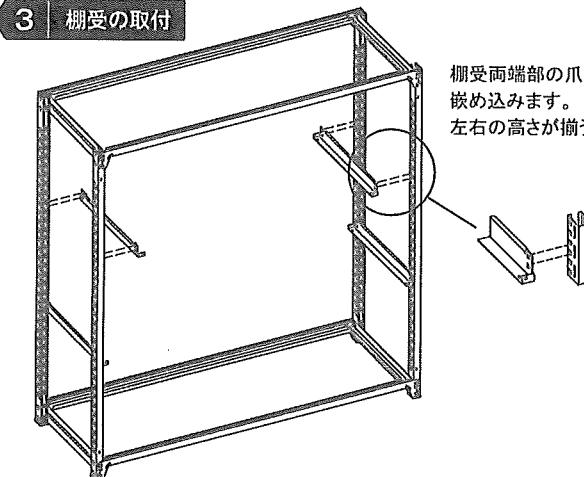
棚受両端部の爪を支柱側面の角孔に嵌め込みます。
