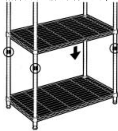
棚を立てて、2と同様にボールに固定部品をセットし棚を固定部品取り付け位置まで下げて固定します。以下同じ手順で棚を増やします。
