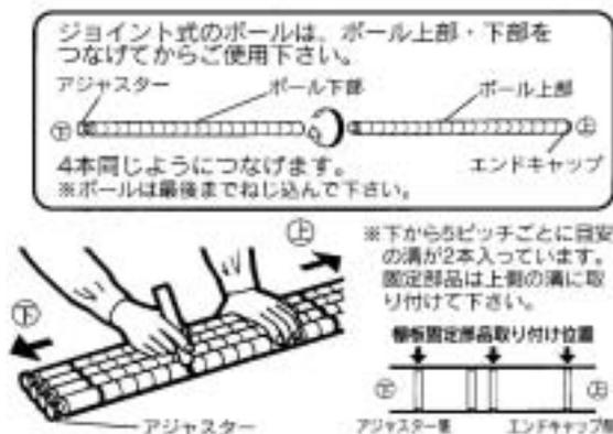
棚にのせる物の大きさに合わせ、棚の取り付け位置を決めます。取り付け位置にマーカーなどで印をつけておくと作業しやすくなります。ポール上・下の確認はアジャスター側が下方向になります。
