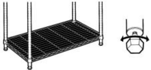
床が水平でない場合は、ボール下部のアジャスターを回してガタツキがないように調整して下さい。
