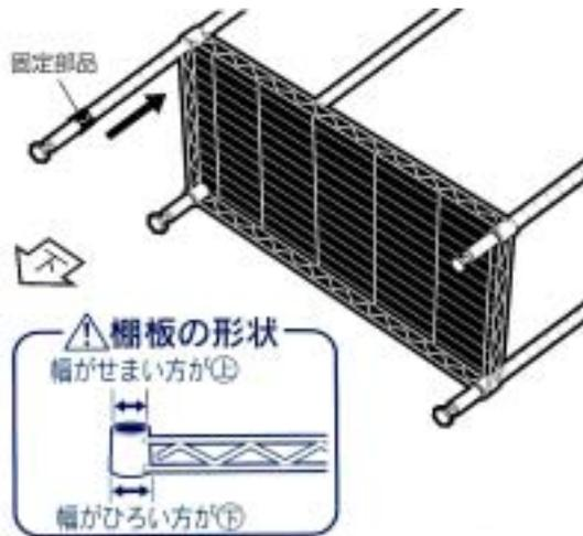
棚を横にして、四すみの差し込み穴にボールの固定部品まで差し込みます。棚には必ずボール上部から差し込みます。
