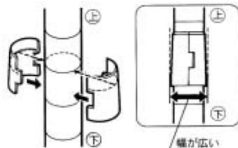
最下段の棚から組み立てますので、棚の取り付け位置最下段に、固定部品を図のようにセットします。このときポールの溝に固定部品内側の凸がピッタリ合うようにセットします。固定部品は幅が広いほうを下にセットして下さい。
