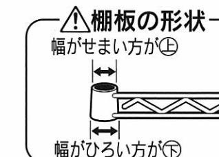
棚板を横にして、下側からポールを固定部品取り付け位置まで差し込み固定します。
