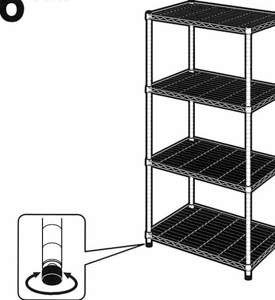
床が水平でない場合は、ポール下部のアジャスターを回してガタツキがないように調整してください。
