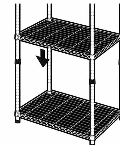
全体を立てて、2と同様にポールに固定部品を取り付け、次の棚板を固定します。
