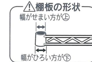
棚板を横にして、下側からポールを固定部品取り付け位置まで差し込み固定します。
