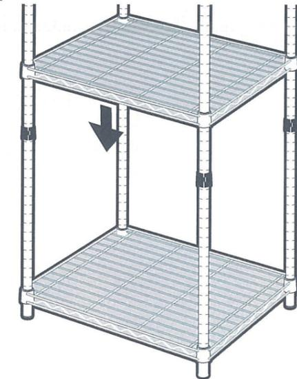
棚を立てて、2と同様にポールに固定部品を取り付け、次の棚板を固定します。
