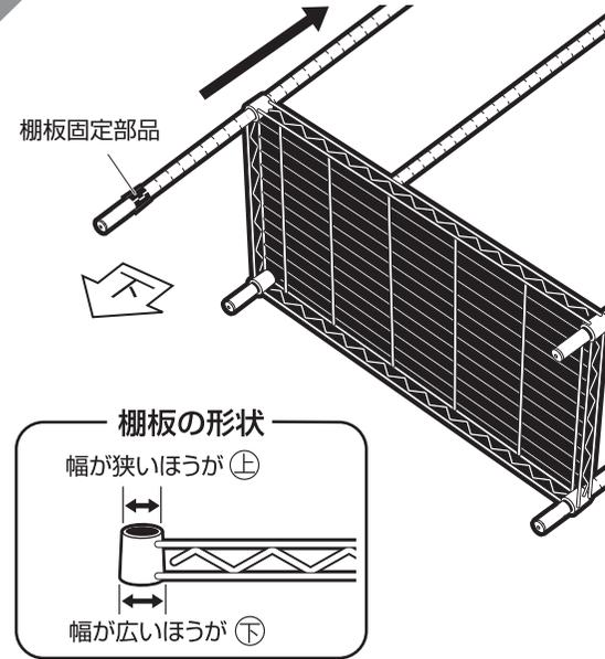
棚板を横にして、下側からポールを棚板固定部品取り付け位置まで差し込み固定します。
