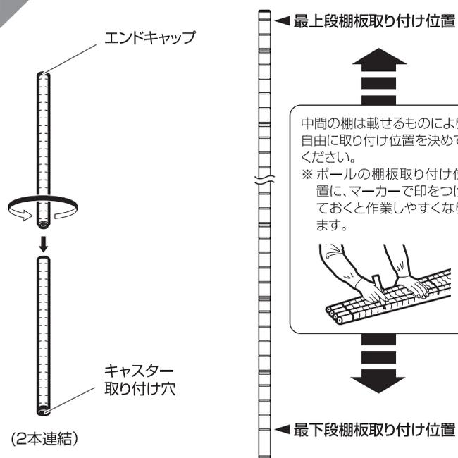
※ ジョイント式ポールは、連結して使用します。ジョイント部はしっかり締めてください。
