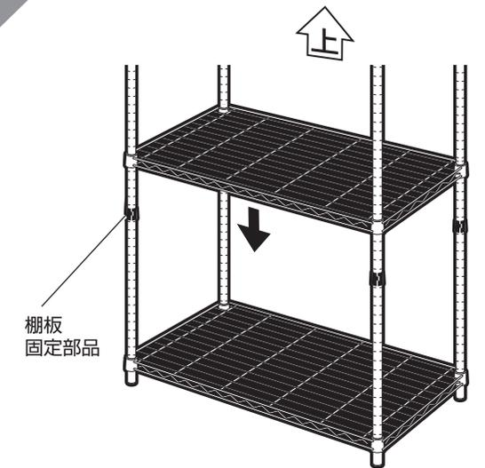
全体を立てて、2と同様にポールに棚板固定部品を取り付け、次の棚板を固定します。以下同じ手順で棚を増やします。
