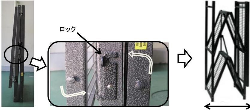
② ラッチを掛けます。(A) (フックに掛けにくい時は上部フレームを少し押しします。)
