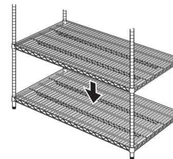
全体を立てて、▼と同様にポールに棚板固定部品を取り付け、次の棚板を固定します。以下同じ手順で棚板を増やします。
