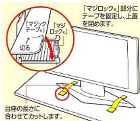
台座を固定するテーブル等の上にマジックロック付成型ボックスを設置し、マジックテープを台座のサイズに合わせてカットします。マジックロック付成型ボックスの上蓋を開けてマジック部分にテープをしっかりと固定し、余り部分をカットして上蓋を閉めます。
