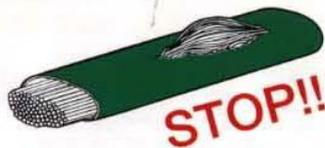
外側の布が擦過や引っ掛けなどによって破損し、内部の芯糸(白)が見えてきたら使用を中止してください。また部分的な硬化や太さの不均一が感じられたら危険な状態です。
