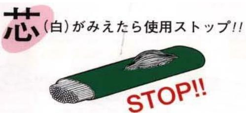
外側の布が擦過や引っ掛けなどによって破損し、内部の芯糸(白)が見えてきたら使用を中止してください。
