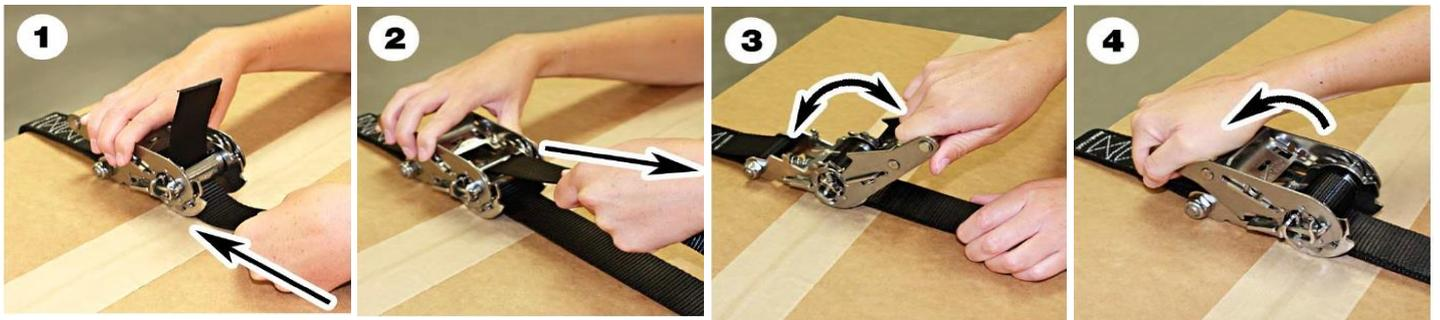
① ベルトのフリーの端を閉じたバックルの巻取り軸(A)の中央の下から通す。
