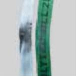
Verformung durch Wärmeeinfluss (z. B. Reibung, Strahlung) oder Quetschungen vorhanden sind
