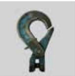
Nicht austauschbare Beschlagteile die durch Überlastung oder Verschleiß verformt wurden (Verbiegungen, Kerben, abgeschliffene Stellen an den Auflagepunkten etc.)
