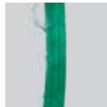
Eine Vielzahl kleinerer Kantenbeschädigungen in kurzen Abständen vorliegt oder das Zurrgurtesband im Gewebzentrum beschädigt ist
