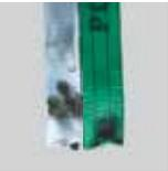
Das Gewebe durch Hitzeeinwirkung (durch z. B. Funkenflug oder Schweißperlen) beschädigt ist
