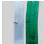
Garnbrüche oder Garnschnitte im Gewebe von mehr als 10 % des Querschnittes des Zurrgurtes oder Webkanteneinschnitte („Webkanteneriss“) vorhanden sind
