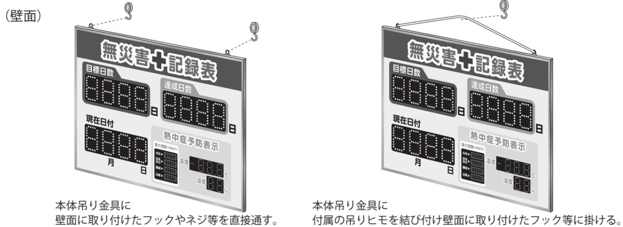
本体吊り金具に壁面に取り付けたフックやネジ等を直接通す。
