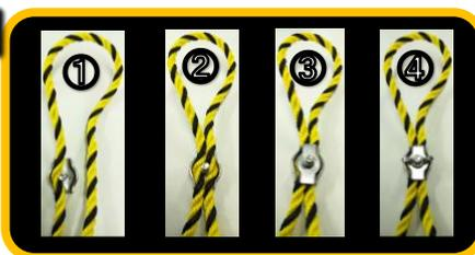
輪っかの作り方>>①②金具にロープをはめ込み輪っかを作る③押し板を置く④蝶ネジで板を押してロープを奥まで押し込み完成!
