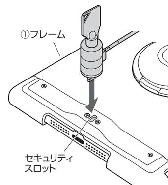
④鍵を反時計回りに約90°回転し、抜き取ると施錠されます。
