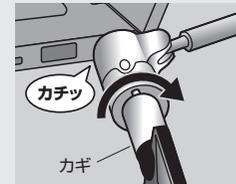
①カギを錠の穴の形に合わせて差し込み、右回りに90°回転します。「カチッ」と音がして開いている先端が閉じるようになります。
