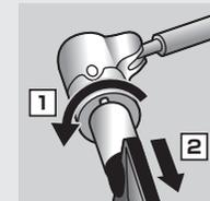
③カギを左回りに90°回転させて錠の穴の形に合わせて、カギを引き抜きます。
